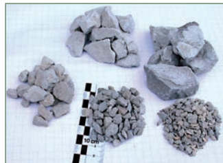
Splitt für Beton und Asphalt
